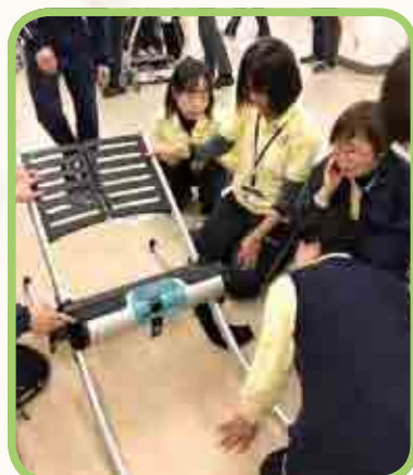
▲床に倒れた状態から自動で座位まで起こすライザー
